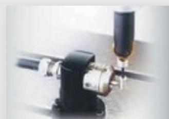
устройство привязки инструмента
